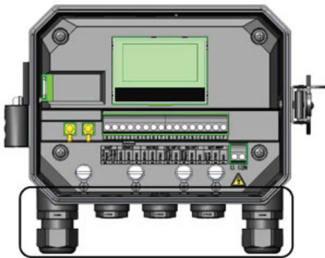
Rysunek 24: Zalecane zastosowanie dławnic kablowych
